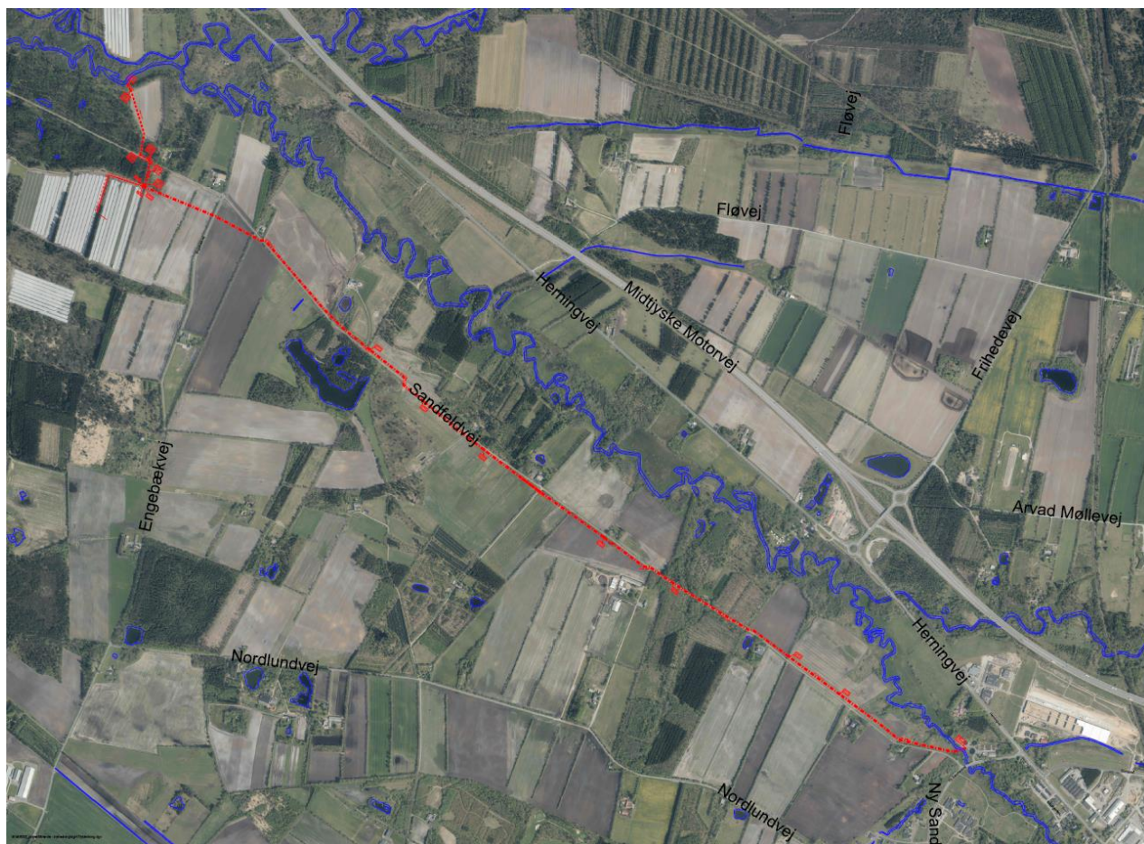
Figur 1: Foreslået ledningstrace mellem Sandfeld Renseanlæg og nyt udløbspunkt (Blå er vandløb, rød er ledningstrace).
