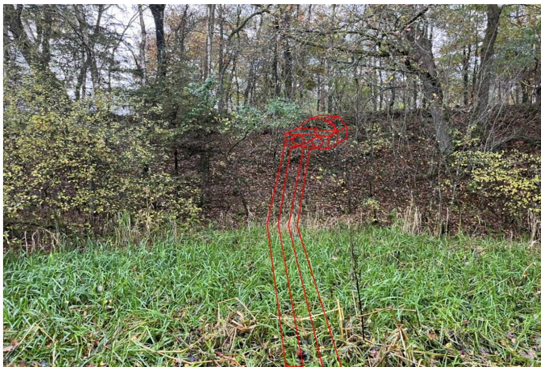
Figur 2-10: Principkitse for manifoldbygværk, hvor \varnothing 600 mm indløbsledning deles op i 2 stk. \varnothing 400 mm udløbsledninger, som føres på terræn.
