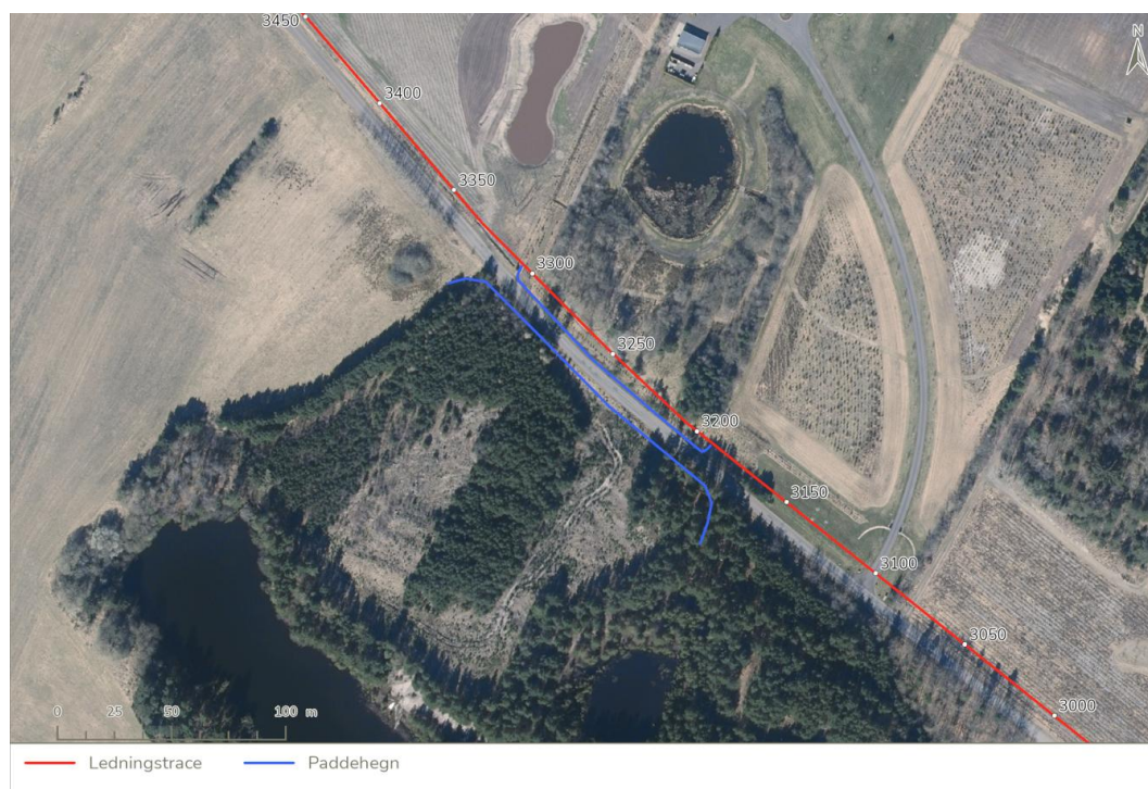
Figur 12-4. Skitsering af paddehegnet på den potentielle vandringsvej for spidssnudet frø.
