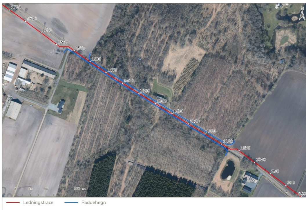
Figur 11-6. Skitse af paddehegnet der løber på tværs af den østlige spredningsvej for padder og krybdyr.
