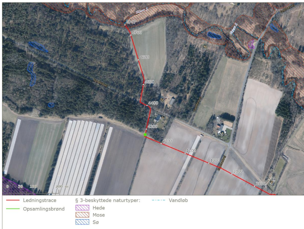
Figur 2-5: Alternativ ledningstracer ved strækning st. 3055-4460. Alternativ 2 vil ligge i vejkanthen og ikke i vejen.
