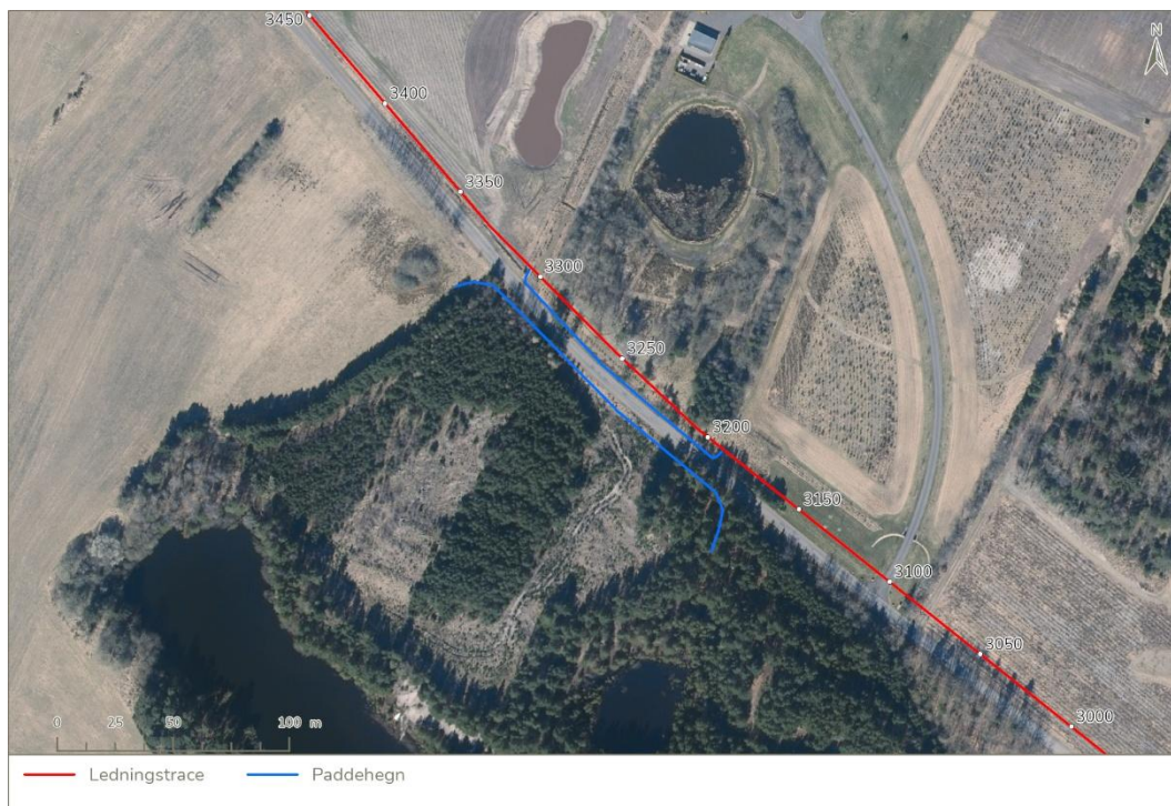
Figur 11-5. Skitse af paddehegnet der løber på tværs af den vestlige spredningsvej for padder og krybdyr.
