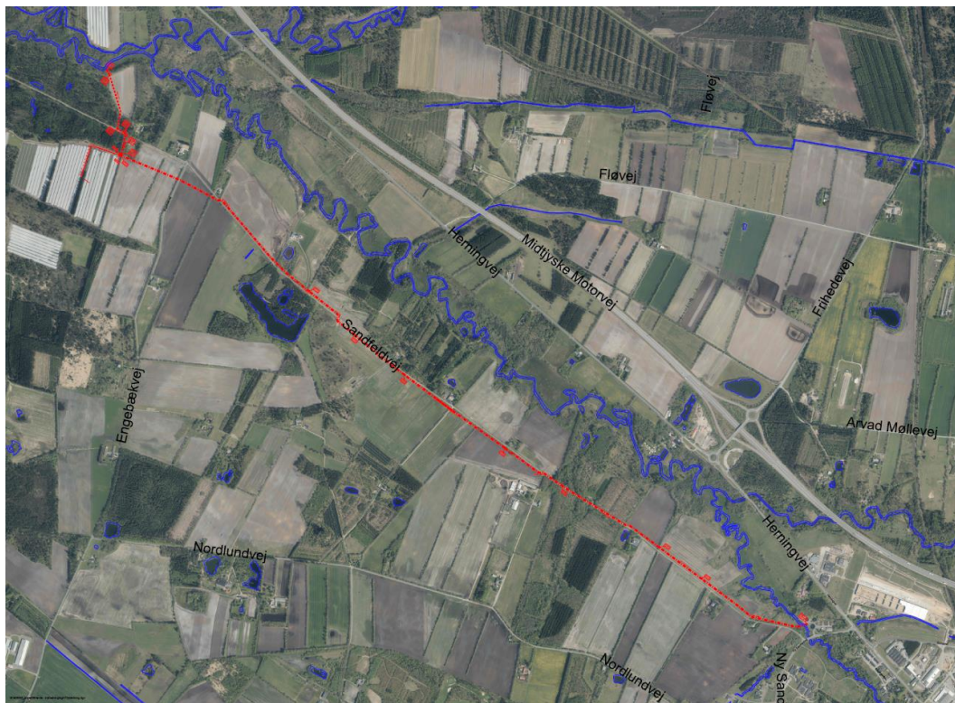
Figur 14-17 Foreslået ledningstrace mellem Brande Renseanlæg og nyt udløbspunkt (Blå er vandløb, rød er ledningstrace)
