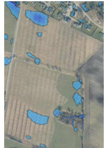
Det fremgår af skybruds- og lavningskort (Scalgo-Live), at ca. 8100 m 2 af lokalplanområdet er i risiko for regnvands-betingede oversvømmelser
