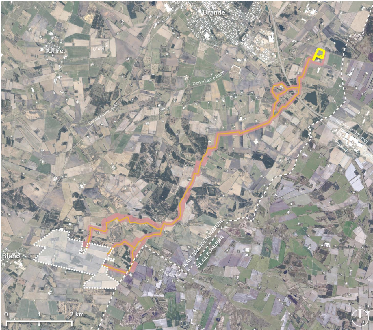
Figur 2: Projektområdets afgrænsning vist med hvid prikket linje. Mulige forløb på kabeltracéet til nettilslutning af solcelleanlægget er vist med orange linjer. Nettilslutningspunktet (vist med gul linje) ved den eksisterende station Askær er fastlagt, men da det endelige kabeltracé ikke er fastlagt, er der udlagt en buffer på op til 150 meter omkring de foreløbigt mulige traceer (lyserød flade). Denne buffer udgør det areal der kan blive berørt ved etablering af det endelige kabeltracé.
