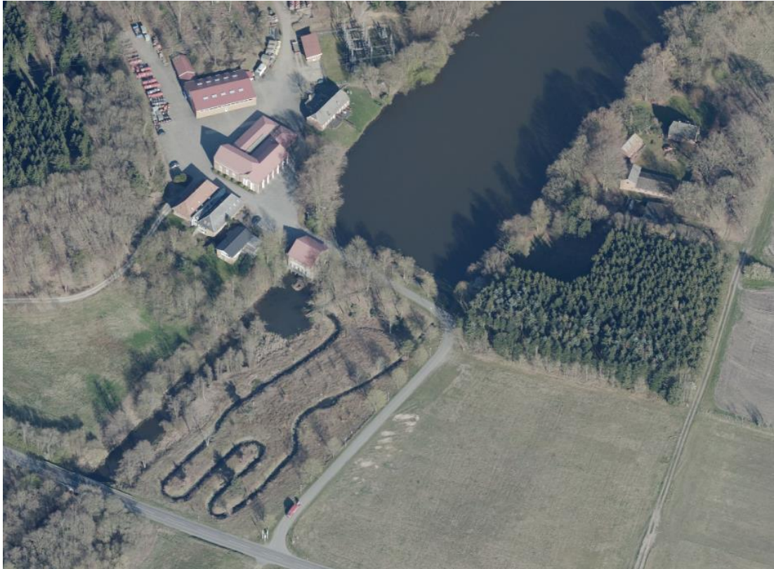
Figur 3-2. Det nuværende 430 meter lange omløbsstryg ved opstemningen til MES Sø er etableret af Ringkøbing Amt i 1990.
