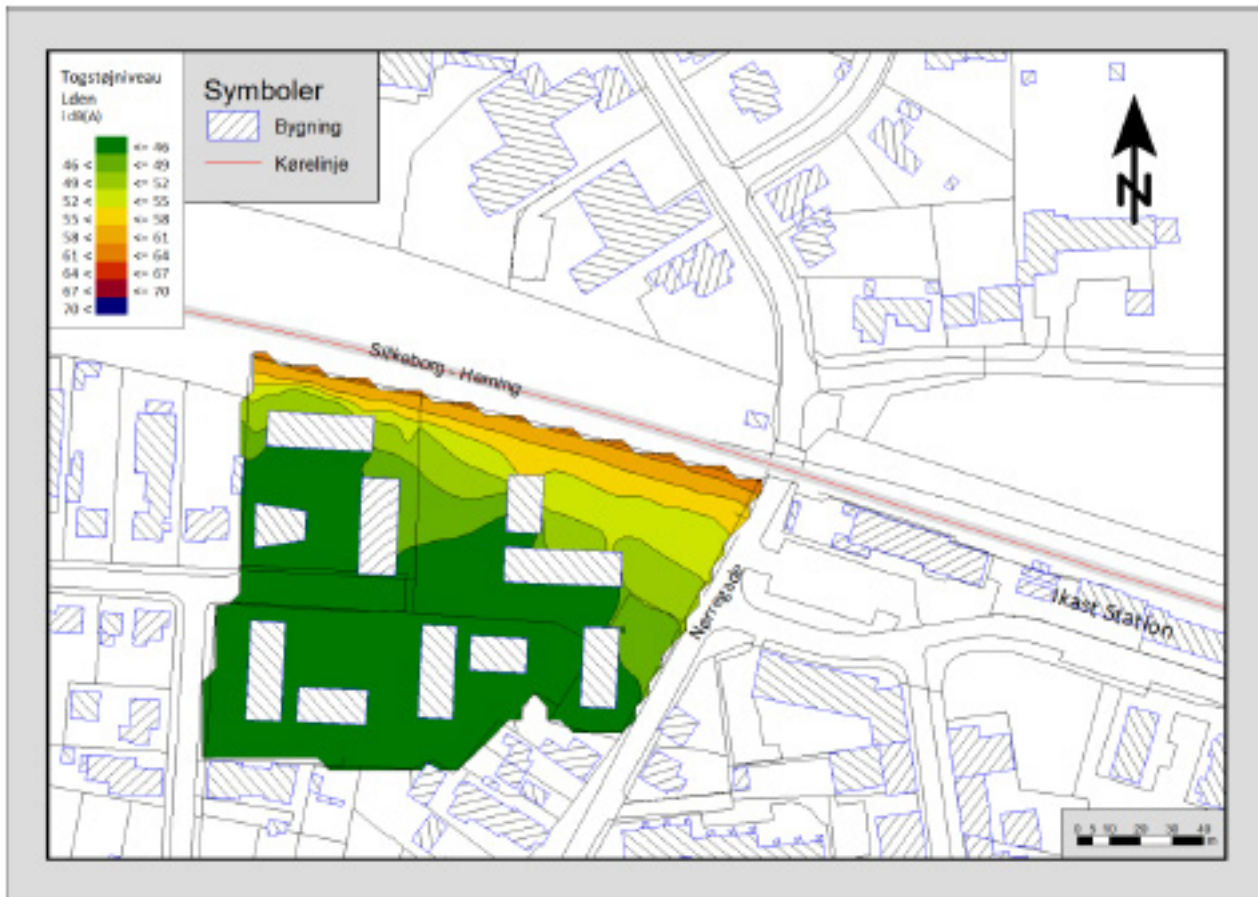
Figur 4. Konturkort for togstøj 1,5 meter over terræn.
