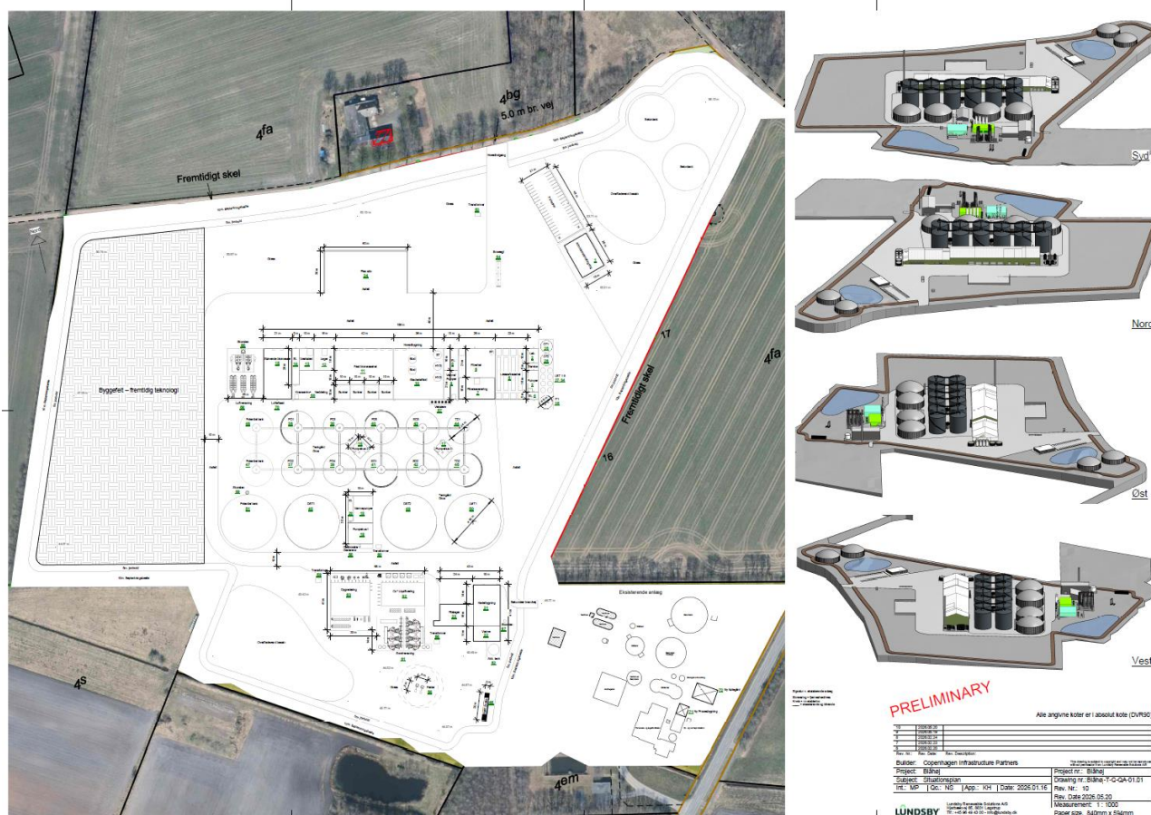
Figur 4-2 Forventet situationsplan for biogasanlæg inkl. volde og beplantningsbælte. Situationsplan også vedlagt som bilag 2. Anlægsdesignet kan betragtes som worst case.
