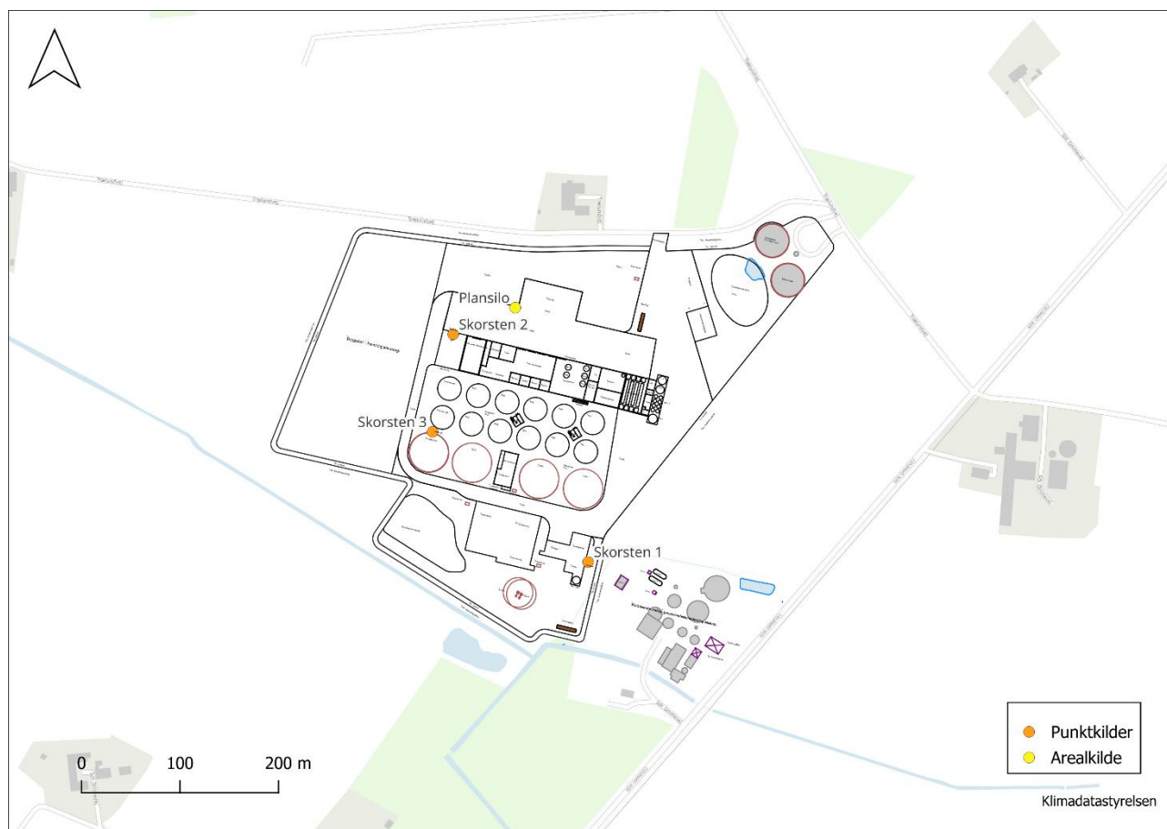
Figur 9-2 Areal - og punktkilder anvendt til OML-beregning.
