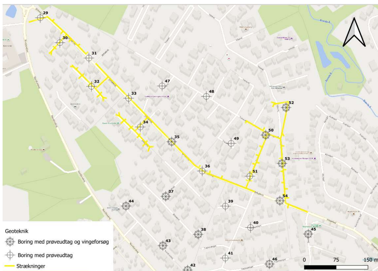
Figur 1 Oversigt over strækningen for etablering af nye kloakledninger (gule linje), der er ikke kortlagt jordforurening i området, hverken vidensniveau 1 (V1) eller 2 (V2). Geotekniske borer udført som en del af projektet er ligeledes vist.
