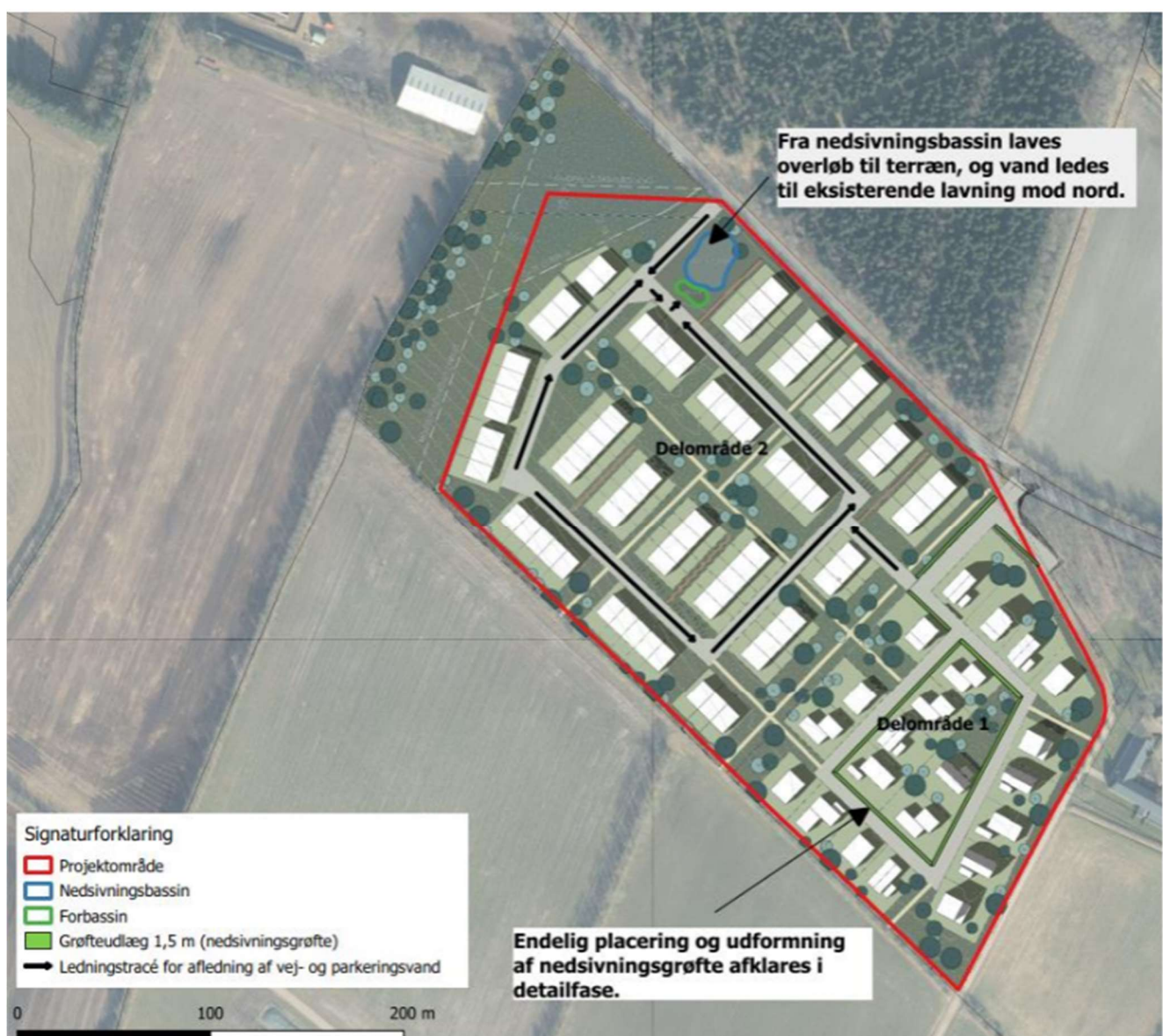
Figur 3.3: Eksempel på figur, der viser placering af ledningsanlæg, grøfte og bassin.
